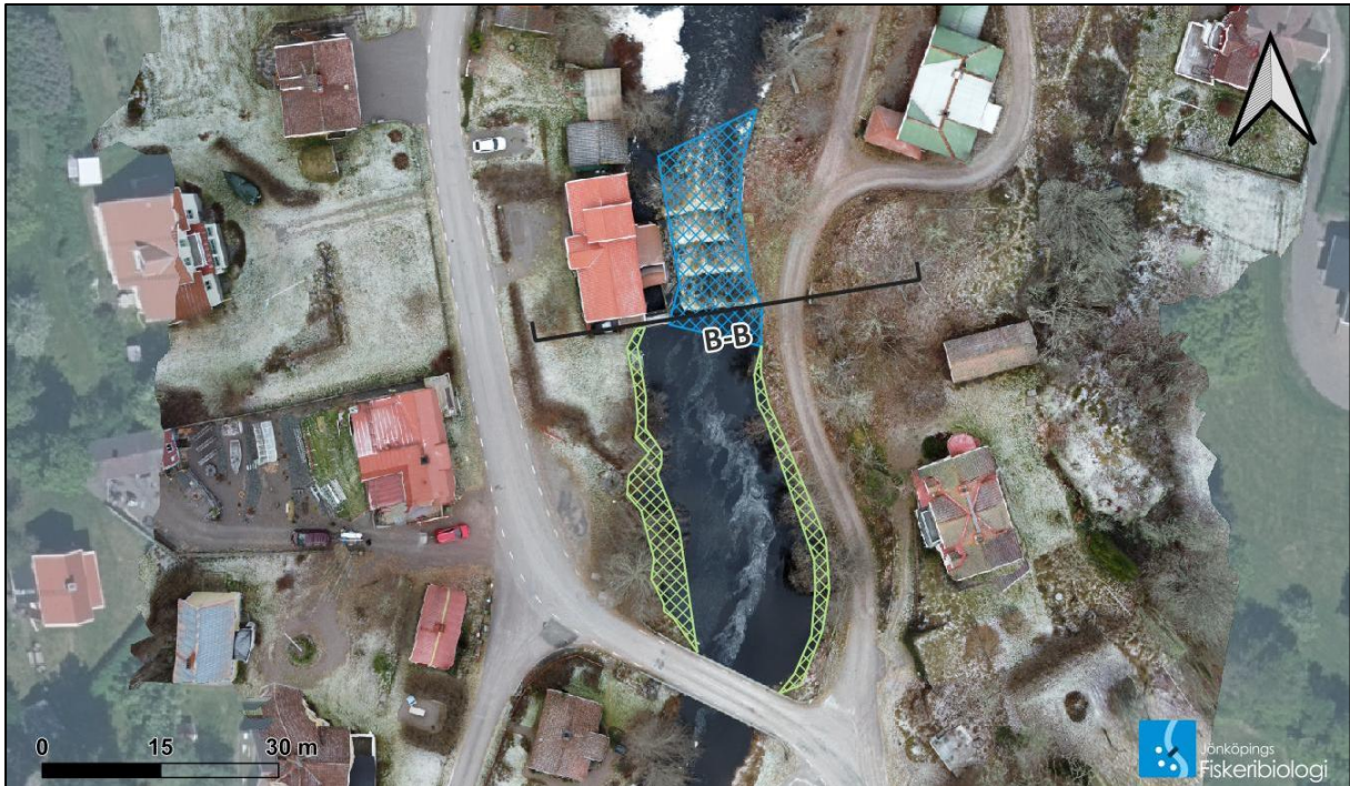
Figur 17. Botten inom det område som är markerat med blått rutnät kommer att få en lutning på cirka 5 %. I dammläget (sektion B-B) kommer ny tröskel att återskapas enligt figur 16. Områden markerade med grönt rutnät förväntas torrläggas.
