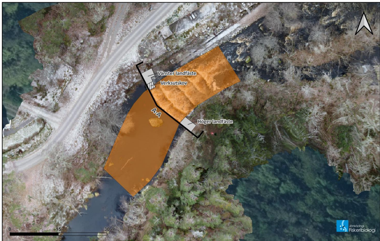
Figur 13. Det område vid Mörtfors övre vattenkraftsanläggning som förväntas återfå en strömmande till forsande karaktär efter åtgärd. Botten inom det markerade området kommer att få en lutning på cirka 4 % och i dammläget (sektion A-A) sänks botten cirka 1,5 m.
