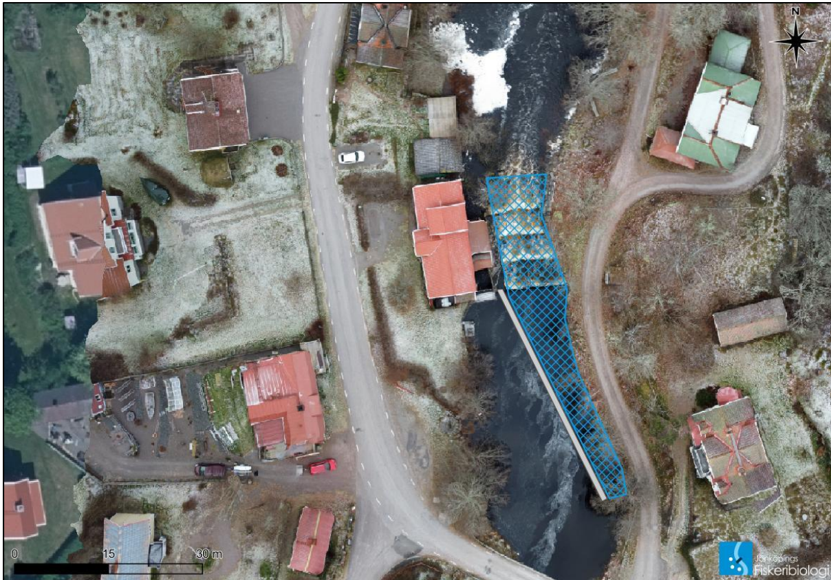
Figur 20. Skiss avseende den principiella utformningen av åtgärdsalternativet med ett inlöp utmed höger sida vid Mörtfors kvarn.
